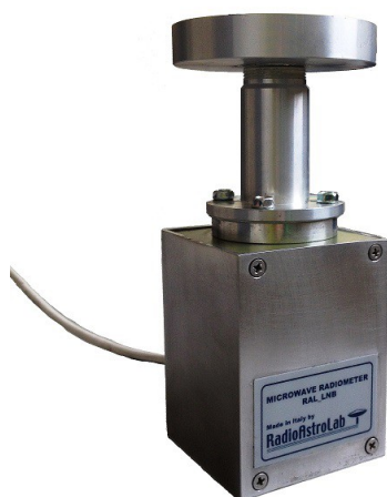
Fig. 6: RAL10_LNB Unité extérieure avec RAL10_FEED pour une antenne parabolique circulaire. Il doit être installé au point focal de l'antenne, "prime focus" avec un rapport F/D entre 0,32 et 0,43. Les unités RAL10_LNB et RAL10_FEED ont une bride du type guide d'ondes circulaire C-120.
